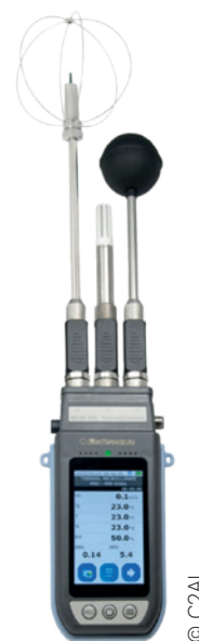
▲ Modèle d'appareil de mesure de l'indice WBGT.
